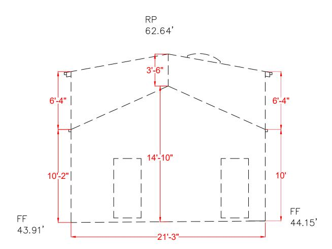
3 GARAGE SIDE/NORTH ELEVATION (TO BE DEMOLISHED) SCALE : 3/16":1'0"
